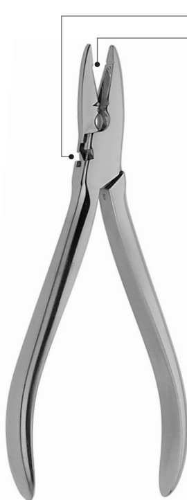
WALDSACHS Universal Pliers for soft and hard wire Universalzange für weichen und harten Draht ○ Max. Ø 0,7mm / .028" □ 1,30 x 0,65mm / .052 x .026" [ 150mm 631/3
