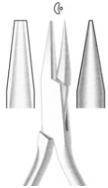
SCHWARZ Hollow Chop Pliers for soft and hard wire Hohlkehlzange für weichen und harten Draht Ø Max. Ø 0,5mm / .020" [ 140mm 630/13
