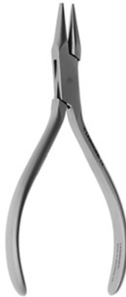
SCHWARZ Hollow Chop Pliers for soft and hard wire Hohlkehlzange für weichen und harten Draht Ø Max. Ø 0,5mm / .020" [ 140mm 630/13
